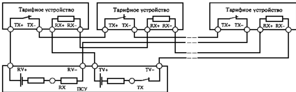
Рисунок 1d - Схема четырехпроводной линии с несколькими исполнителями
