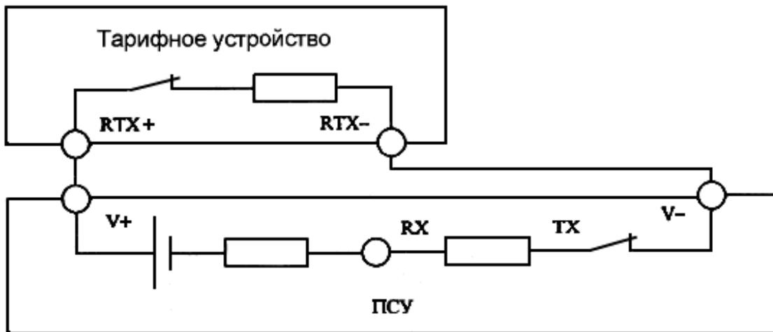
Рисунок 1а - Схема двухпроводной линии с одним исполнителем
