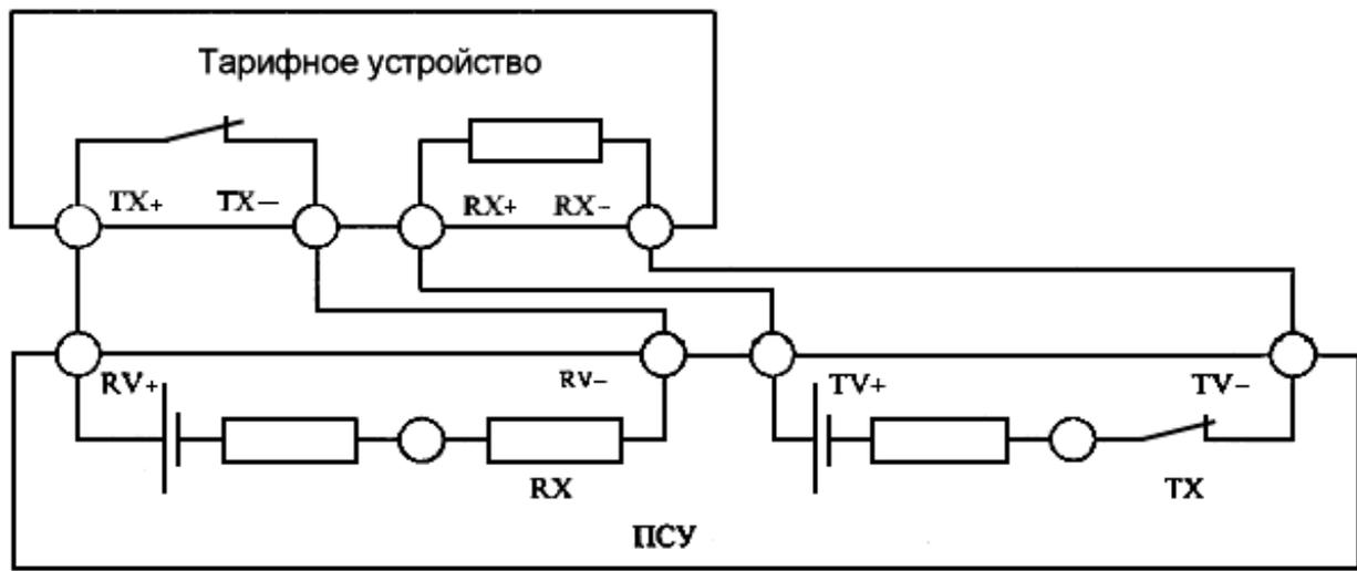
Рисунок 1с - Схема четырехпроводной линии с одним исполнителем
