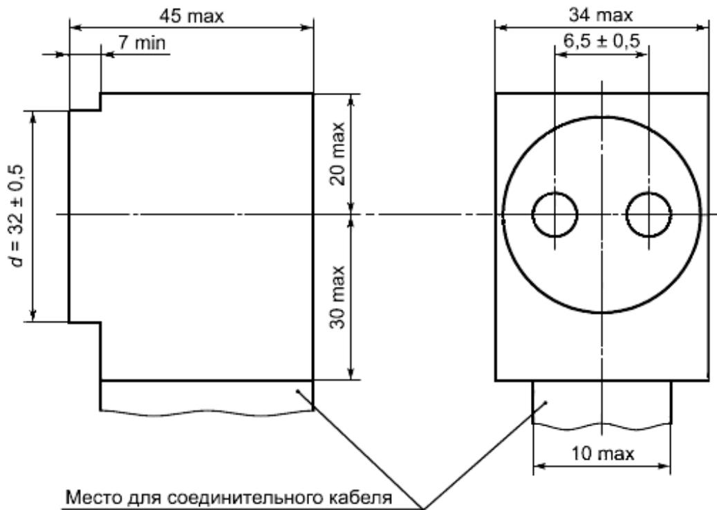
Рисунок 2b - Размеры считывающей головки
