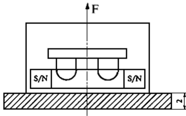
Сила сцепления  $F \geq 5$  Н при контакте с пластиной;
