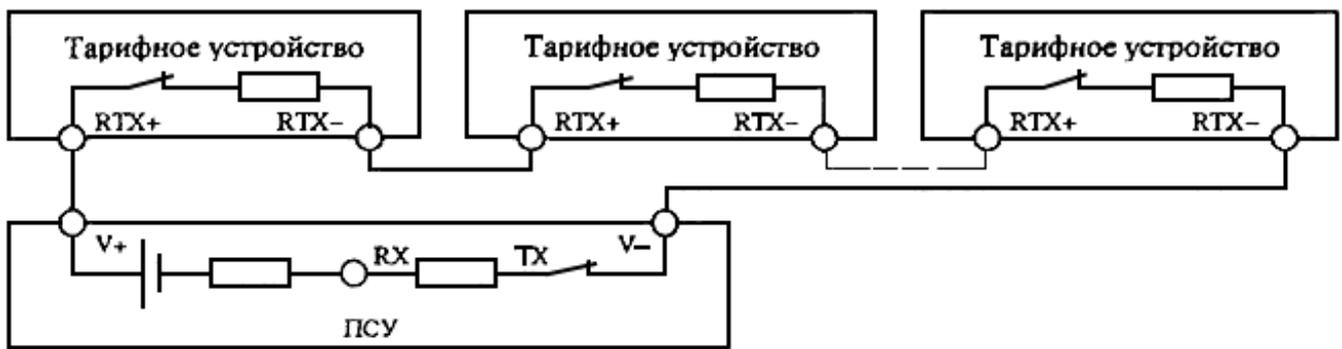
Рисунок 1b - Схема двухпроводной линии с несколькими исполнителями
