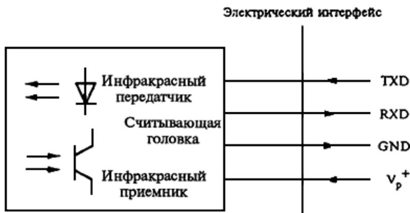
TXD - данные, снимаемые со считывающей головки; RXD - данные, получаемые считывающей головкой; GND - общая точка (напряжение сигналов - напряжение электропитания);  $V_p^+$  - источник электропитания
