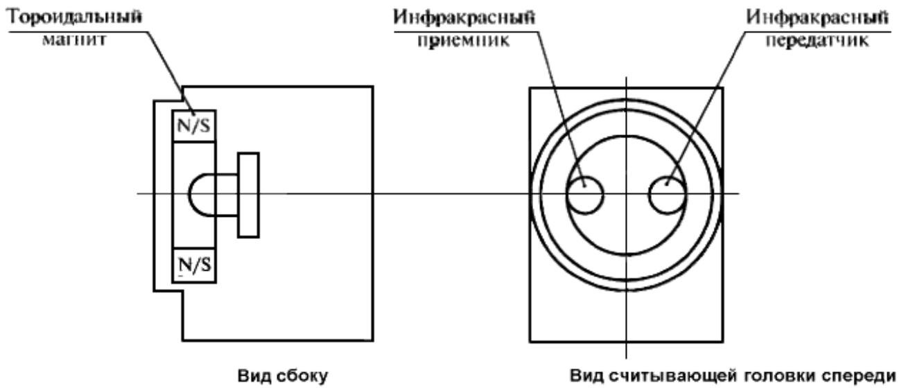
Рисунок 2а - Расположение компонентов на считывающей головке
