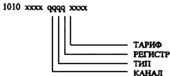
Единица в соответствующей битовой позиции указывает, что поле может принимать все возможные значения. Ноль указывает, что поле фиксировано. Таким образом, неиспользуемые места поля могут быть назначены так, чтобы все регистры КАНАЛА 1 читались или все записи РЕГИСТРА 1 по определенному каналу будут удалены и так далее.
